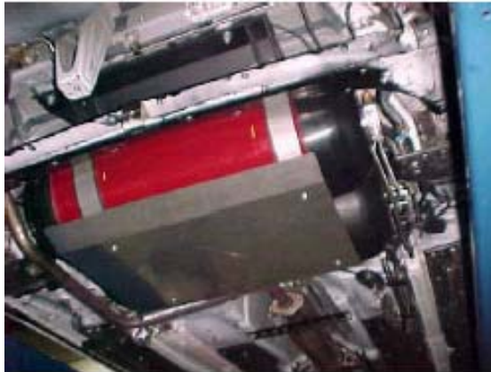
Réservoir H 2 à la place du réservoir essence
